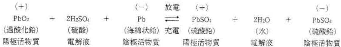
通常、鉛バッテリーはその充電末期になり、硫酸鉛が過酸化鉛と海綿状況になってしまうと、その後の充電電流は専ら電解液中の水の電気分解に使われ、その結果、陽極板からは酸素ガス、陰極からは水素ガスが発生してバッテリー外へ飛散してしまう。従って電解液が減少し補水の必要性が出てくる。
