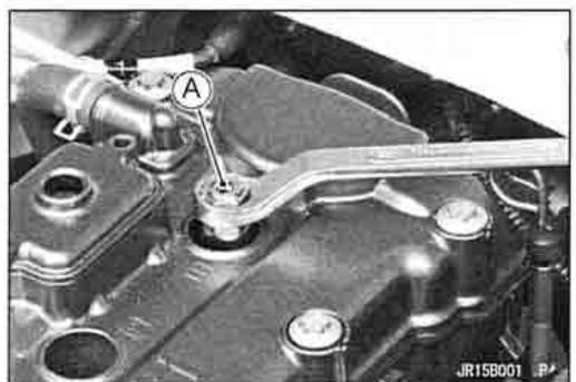
● スパークプラグを、できればプラグクリーナを使用して清掃し、最後に研磨粒子を取り除く。あるいは、高引火点の溶剤とワイヤブラシ等を用いて清掃してもよい。
