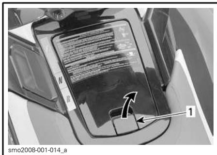
GTX、RXT、WAKE モデル — ラッチを引いて解除する
