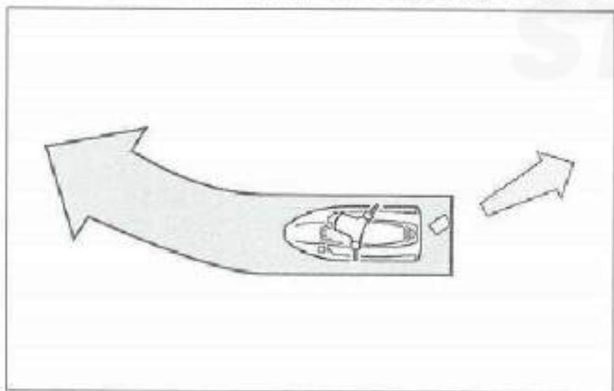
スロットルレバーを完全に放すとジェットポンプの推力が殆どなくなります。ウォータクラフトはゆっくりとまわり、旋回能力は低下します。
