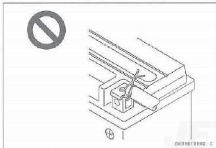
(3) 端子が変形・破損するため、端子部をハンマーでたたかないこと。
