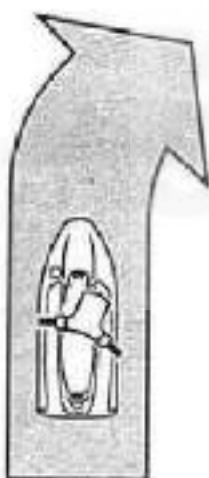
スロットルを使うことも、もう一つの旋回方法の重要な要素です。スロットルレバーを引くとジェットポンプにより推力が生じ、進路変更ができるようになります。
