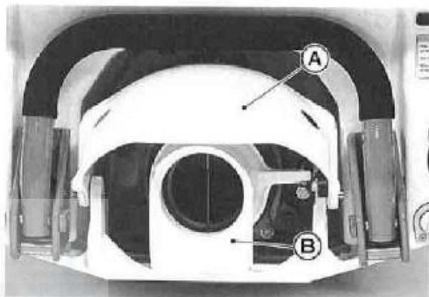
A. リバースバケット      B. ステアリングノズル
