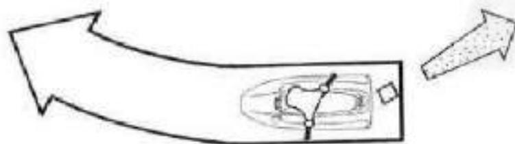
スロットルレバーを完全に放すとジェットポンプの推力が殆どなくなります。ウォータークラフトはゆっくりとまわり、旋回能力は低下します。
