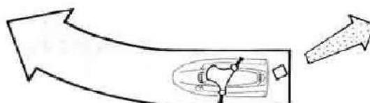
スロットルレバーを完全に放すとジェットポンプの推力が殆どなくなります。ウォータークラフトはゆっくりとまわり、旋回能力は低下します。
