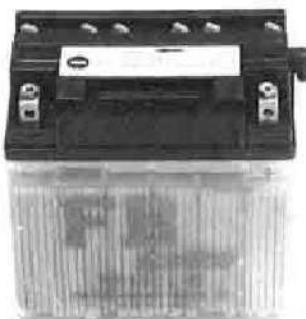
バッテリ液面がバッテリケース側面に示されている上限と下限のマークの間にあるようにして下さい。バッテリ液面が低くなったら、バッテリのフィラキャップを取り外し、蒸留水を各セルとも上限のマークに達する迄注入して下さい。
