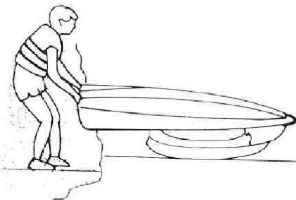
4. しばらくしてからスロットルを開き、スタートボタンを押してエンジンを数回転させます。水がスパークプラグの孔から出てきます。
