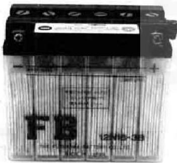
バッテリー液面がバッテリーケース側面に示されてい
