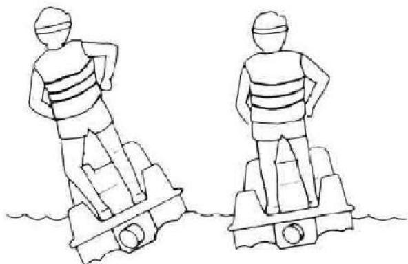
急旋回・高速旋回 緩旋回・低速旋回
