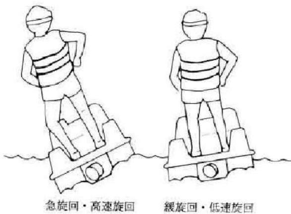
スロットルを使うことも、もう一つの旋回方法の重要な要素です。スロットルレバーを押すとジェットポンプにより推力が生じ、進路変更ができるようになります。
