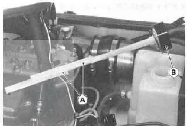
A. 燃料フィルタスクリーン B. アウトレットリングナット
