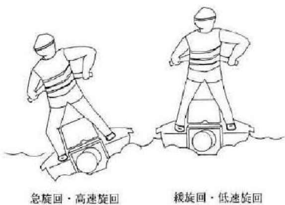
スロットルを使うことも、もう一つの旋回方法の重要な要素です。スロットルレバーを押すとジェットポンプにより推力が生じ、進路変更ができるようになります。
