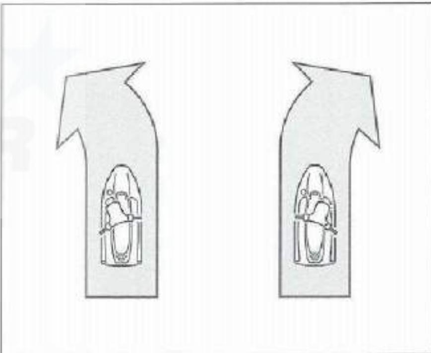
スロットルレバーを使うことも、もう一つの旋回方法の重要な要素です。スロットルレバーを引くとジェットポンプにより推力が生じ、進路変更ができるようになります。
