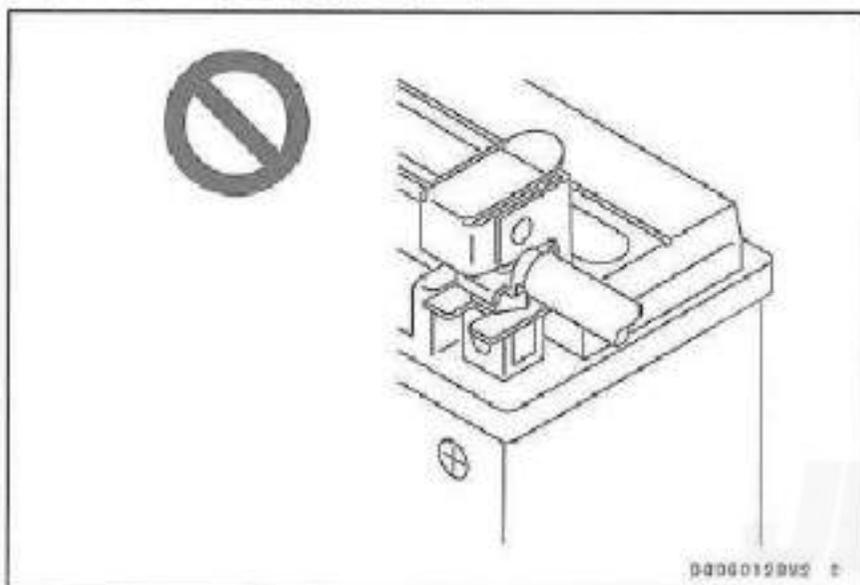
(5) 複数のケーブル端子を接続する場合端子間にスキマがないように確実に締め付ける。
